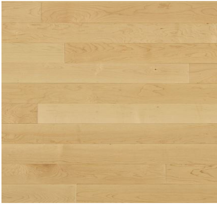
PAVIMENTO Soalho estratificado “Hard maple”. ACABAMENTO: 15% brilho DIMENSÕES: Réguas de 120 mm de largura e 12 mm de espessura com micro bisel. Composto por 9mm de contraplacado + 3mm de lamela de madeira nobre.
