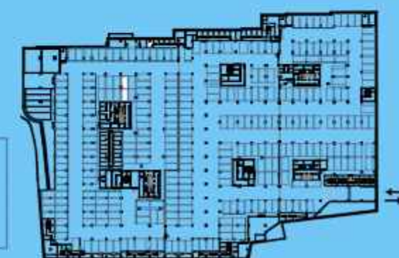
PLANTA PISO ESTACIONAMENTO -2 / PARKING FLOOR -2
