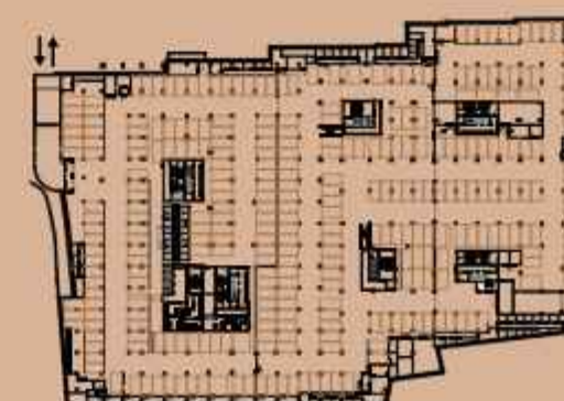
PLANTA PISO ESTACIONAMENTO -1 / PARKING FLOOR -1
