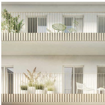
Terraços com guardas exteriores de varandas em prumos verticais de aço metalizado pintado.
